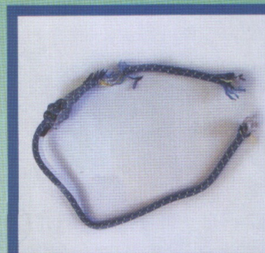
Abb. 1: Als Umlenkung verwendete durchgebrannte Unfallschlinge
